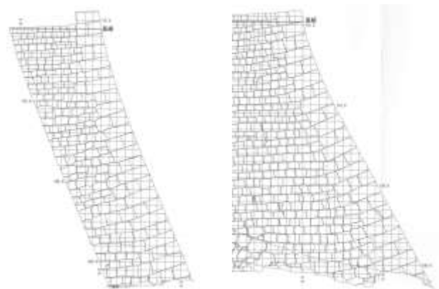
図 3-93 寛文地震の修復石垣(本丸北壁石垣) 2種類の勾配 左: C面角部 右: E面角部
