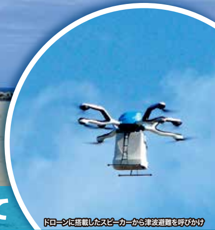
ドローンに搭載したスピーカーから津波避難を呼びかけ
